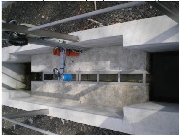
canal de comptage équipé d'une mesure ultrason
